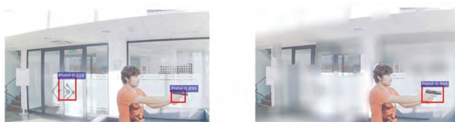
Figura 5. Imagen con la detección original (izquierda) y con el resultado del pre-procesamiento basado en fusión de imágenes por visión binocular (derecha)
