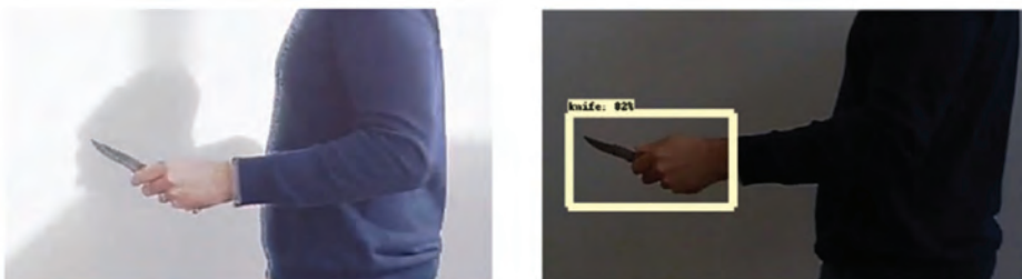
Figura 8. Ejemplo de diferente resultado de detección según la condición de luminosidad
